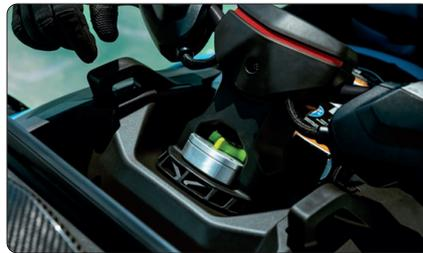
**Amortiguador de dirección hidráulica**
